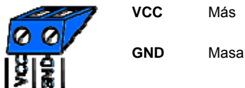
Fig. 2: Conexión de alimentación de tensión (azul)
