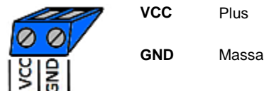
Afb. 2: Aansluiting spanningsvoorziening (blauw)
