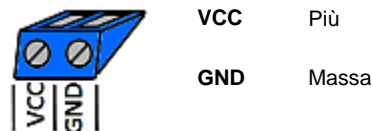
Fig2. Alimentazione di tensione (blu)
