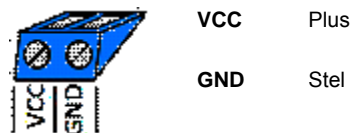
Fig. 2: Tilslutning spændingsforsyning (blå)
