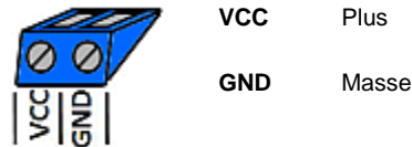
Abb. 2: Anschluss Spannungsversorgung (blau)
